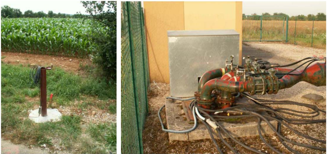
➡ Point d'injection du traceur et point de surveillance (forage ASIA)
